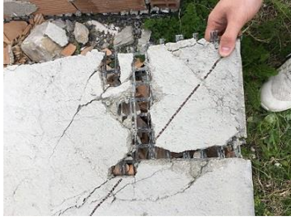
Şekil 7. Kırılan plastik kompozit donatılı duvarda plastik kompozit donatının son durumu
