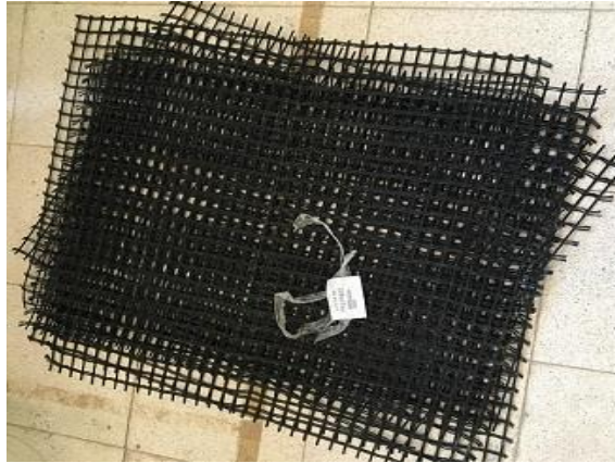
Şekil 3. Plastik kompozit donatı
