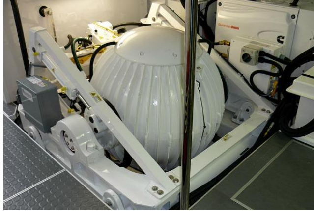
Şekil 5.10. 20 metrelik bir motor yatta gyro stabilizatör uygulaması [22].
