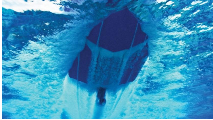
Şekil 5.2. Step'li Karina Uygulmasının Su Altından Görünüşü [14]
