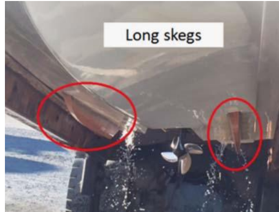
Şekil 5.5. Motorun dıştan takıldığı bir karınada skeg'ler [17]
