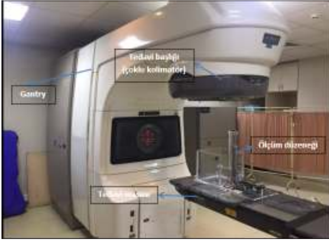
Şekil 5. Oluşturulan sistemin tedavi masasına lateral yerleşimi
