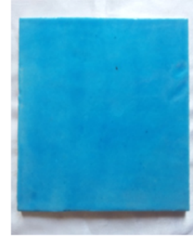
(900 derece alkali sır +%1,5 cuo2) Şekil 28: Astarlı tek fırınlama Figure 28: Primed single fired
