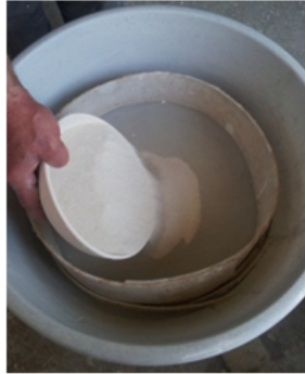
Şekil 2: Kuvarsın Elenmesi (İstenilen tane iriliğine ulaşma)
