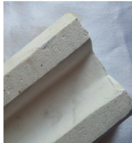
Şekil 30: 6 cm kuvars turkuvaz sırlı tuğla arka yüz Figure 30: 6 cm glazed quartz turquoise brick back side
