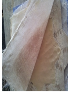
Şekil 9: Basılan hamurun üzerine ayırıcı bez konması
