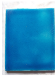
(900derece alkali sır +%2 cuo2) Şekil 21: Turkuvaz çift pişirim. Figure 21: Turquoise double firing.
