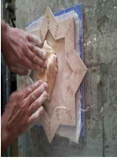
Şekil 8: Yıldız şeklindeki kalıba hamurun basılması Figure 8: pressing the dough into a star-shaped pattern
