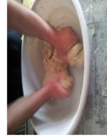
(bünve reçetesi %80 kristalize kuvar kuvarsit %10 kil kaolen %10 bağlayıcı cam tozu)
