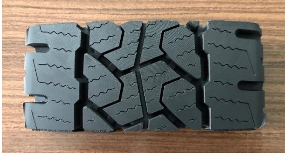
Figure 10. Pictorial view of tire tread pattern produced by Zortrax M200 model three dimensional printer (Zortrax M200 model üç boyutlu yazıcıda üretilen lastik sırt desenin görünümü)
