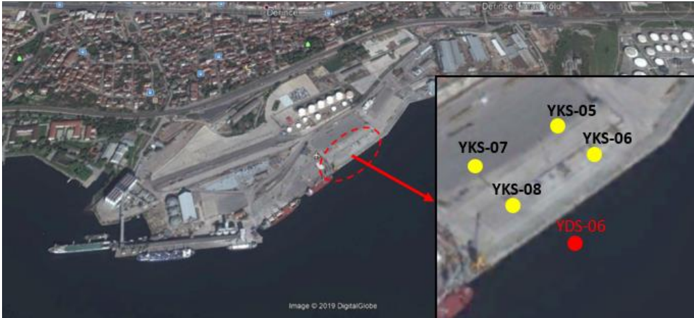
Şekil 4. Sondaj konum planı (Geosan, 2016)
