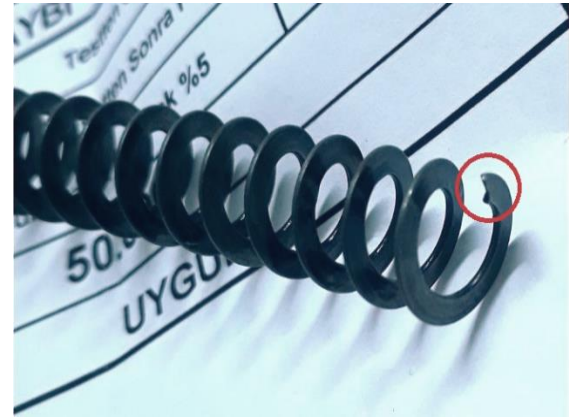
Şekil 17. Yassı tel yayda kırılma
