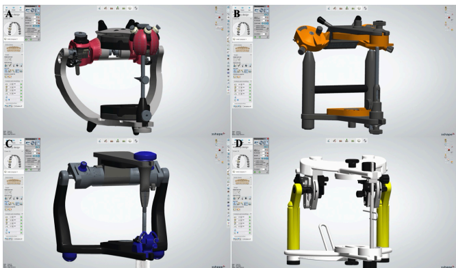
Fig. 3. a: KaVo Protarevo 7, b: SAM 2, c: Artex CR, d: Stratos 300
