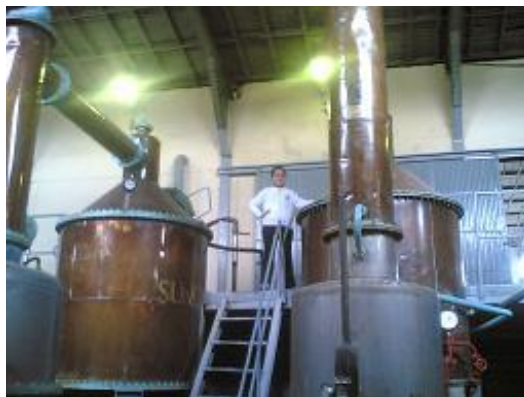
Figure 2. Retorts in a rose oil extraction plant in Isparta (Şekil 2. Isparta'daki bir gül yağı tesisinde imbikler)
