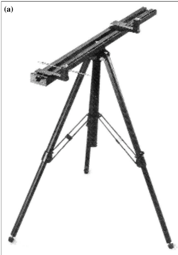
Şekil 1. Aktivite ölçümünde kullanılan fantomlar. (a) Kalibrasyon jigi, (b) silindirik katı fantom.
