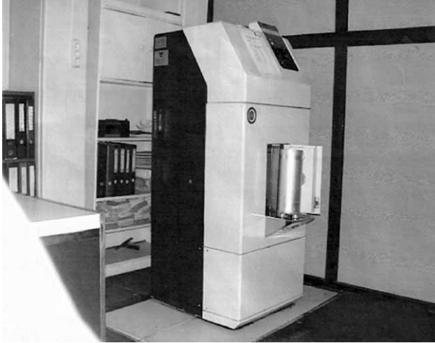
Şekil 1. Bizim Lösemili Çocuklar Vakfı kan ve kan ürünleri ışınlama odası ve cihazı IBL 437C.
