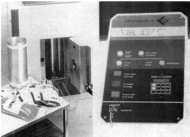
Şekil 2. Işınlanacak kan ürünleri torbaları, ışınlama kutusu (canister) ve cihazın kontrol masası.
