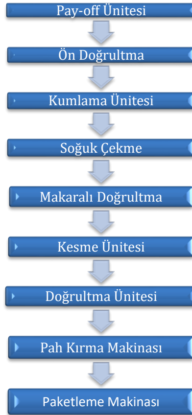
Şekil 1: Soğuk çekme hattı akış diyagramı
