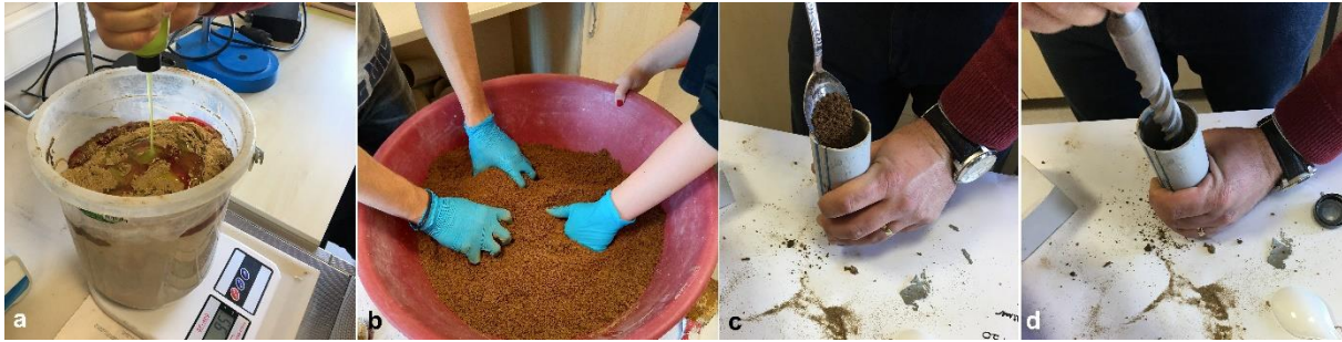
Şekil 2. A) PVA reçinenin tartılarak zeminle karıştırılması, b) Zeminle PVA reçinenin karıştırılması, c) kalıba PVA ve zemin karışımının yerleştirilmesi, d) tokmaktama ile sıkıştırma
