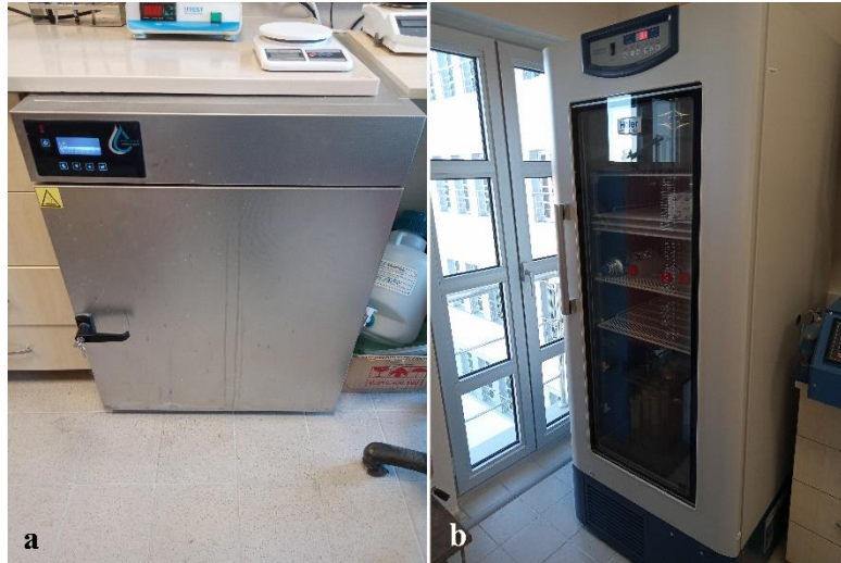
Şekil 3. Isıtma ve soğutma işlemleri için kullanılan etüv (a) ve buzdolabı (b)
