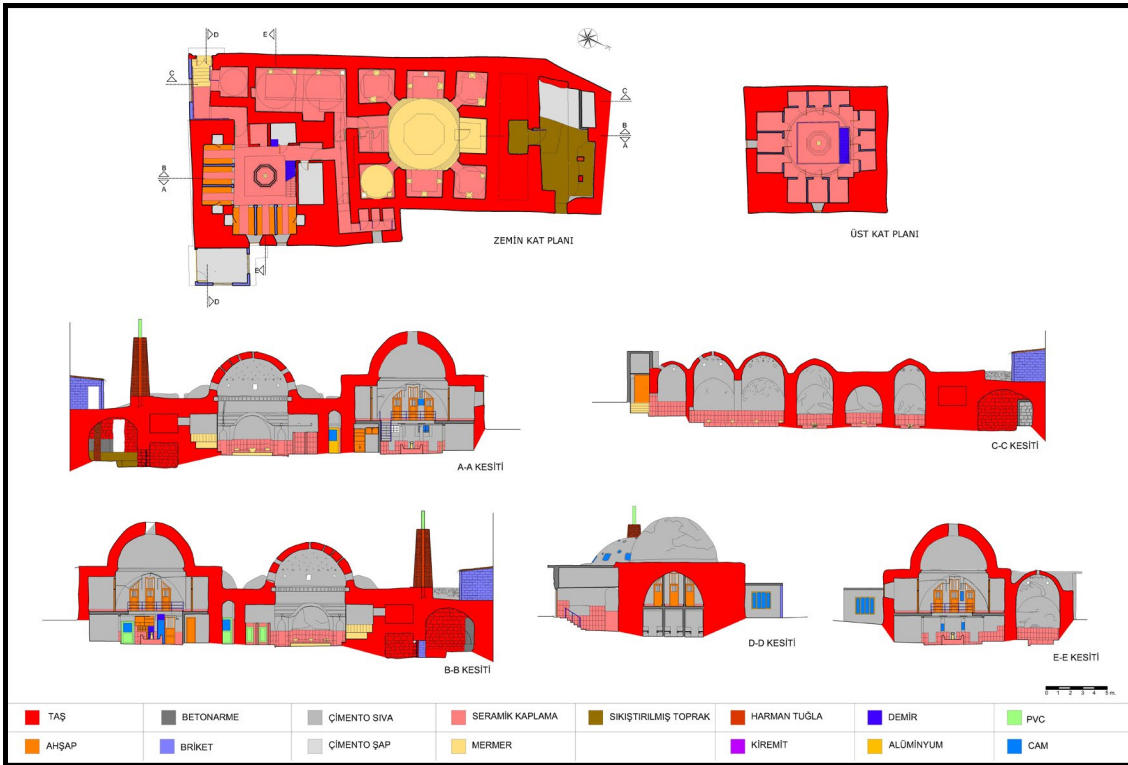
Şekil 10. Tarsus'taki Yeni Hamam'ın malzeme analizlerini gösteren planlar ve kesitler (Öztürk, 2012).
