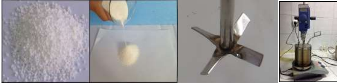
Şekil 1. SBS polimeri, kullanılan başlık ve karıştırma mikseri
