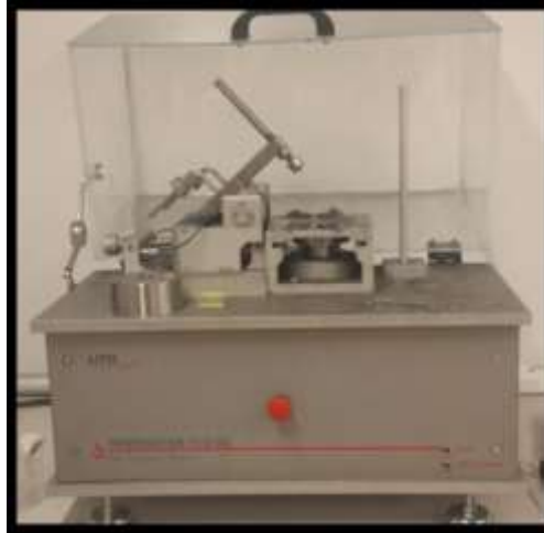
Şekil 1. UTS Tribometer marka aşınma testi cihazı [24]
