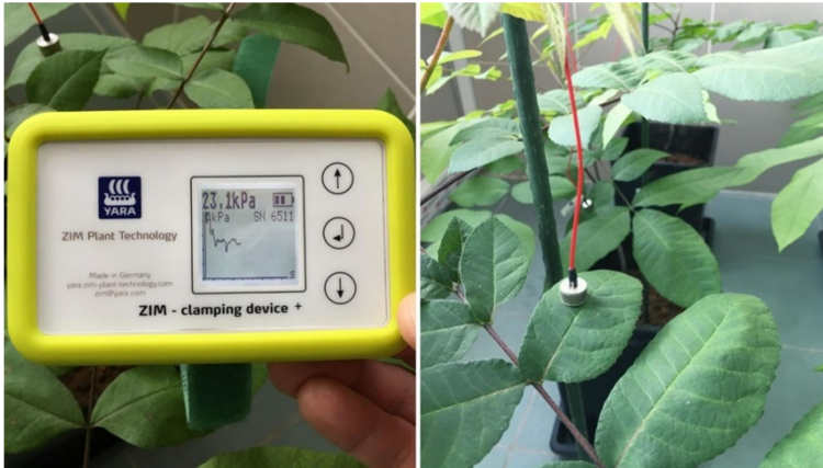
Şekil 3. Yaprak basınç sensörlerinin montajı
