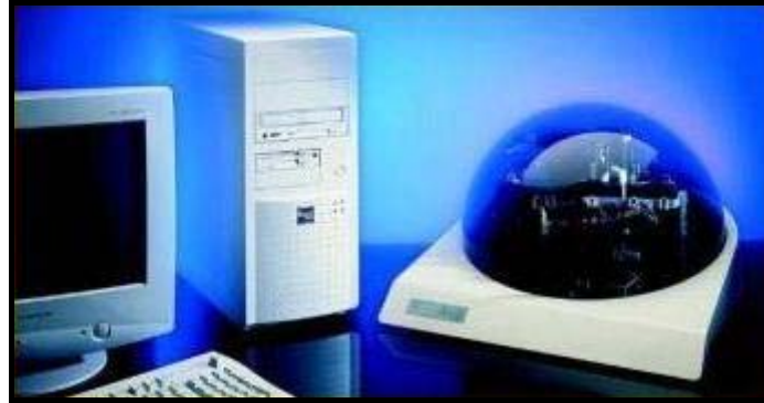
Şekil 3. Radon detektörleri üzerindeki alfa izlerinin analizinde kullanılan RadoMeter 2000 ünitesi (RADOSYS 2008b).
