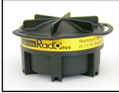
Şekil 1. RSFS tipi pasif nükleer iz detektörünü içeren difüzyon kabı.
