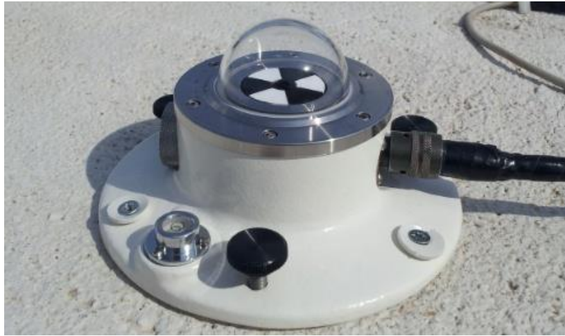
Şekil 4. Toplam ışınım ölçümlerinde kullanılan 8-48 Model Black And White Pyranometer (The Diffuse Pyranometer) ( http://www.eppleylab.com/instrumentation/black_white_pyranometer.htm )
