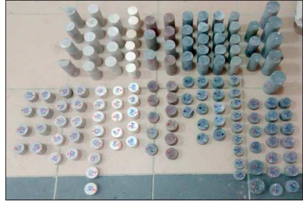
Şekil 6. Kaya mekaniği deneyleri için standartlara uygun olarak hazırlanmış karot numuneler
