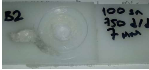
Şekil 8. 750 d/d takım devir sayısı ve 100 sn bekleme süresi için çekme deneyi öncesi SKNK numunesi
