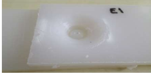
Şekil 9. 1250 d/d takım devir sayısı ve 75 sn bekleme süresi için çekme deneyi öncesi SKNK numunesi
