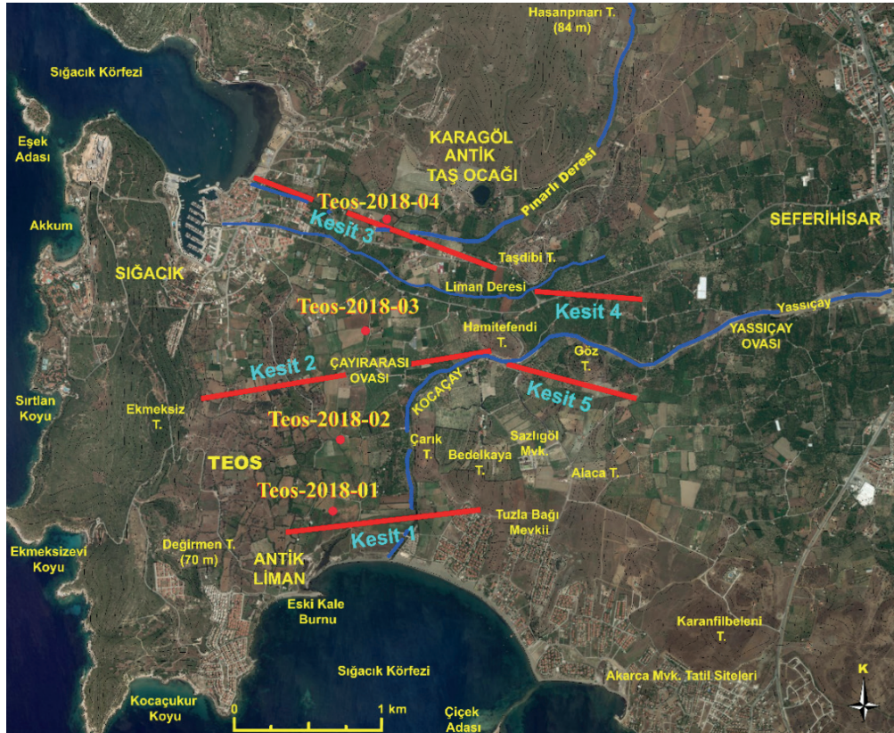
Şekil 9: Teos antik kenti çevresinde delgi sondaj çalışmalarının planlandığı hatlar. Figure 9: Cross-section lines where drilling works are planned around the ancient city of Teos.
