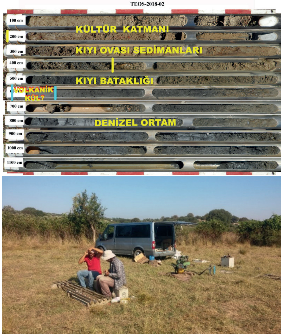
Şekil 7: Sondaj loglarından (üstte) ve sondaj çalışmalarından bir görünüm Figure 7: Images from core drilling log and studies.
