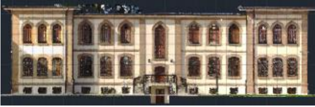
Şekil 8. Cad Yazılımında 3B Nokta Bulutu Verisi Görünümü (Doğu Cephe)
