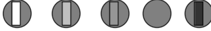
Şekil 2. Zaman-sıcaklık indikatör etiket örneği (Dikdörtgenin rengi dairenin renginden açıksa uygun sıcaklık ve sürede depolanmıştır) [23]
