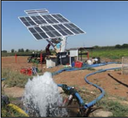
Şekil 9. Seyyar (Mobil) Güneş Pili Sulama Sistemli Prototip Makineye ait görüntü
