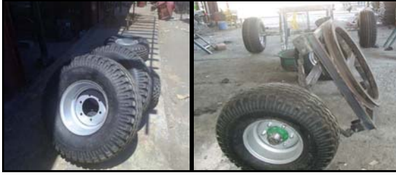
Şekil 4. Tekerlek, makas ve alt römork takımı
