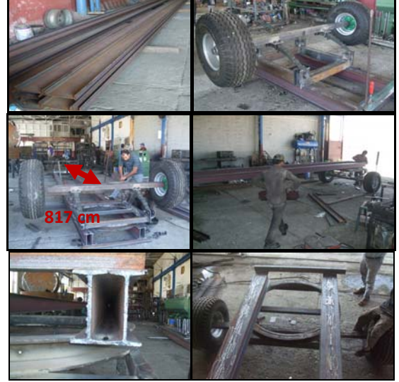
Şekil 5. Alt şasenin yapılışına ait görüntüler
