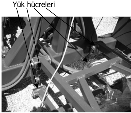
Şekil 6. İtme kuvveti ölçümlerinde kullanılan yük hücreleri
