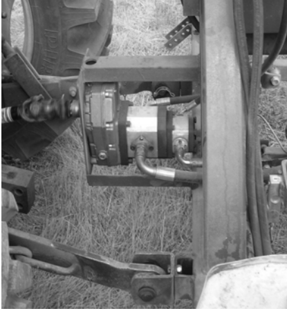
Şekil 2. Üç nokta askı sisteminin düzeneğe bağlantısı
