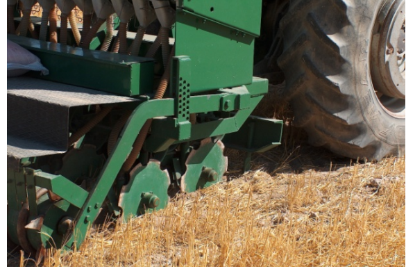
Şekil 1. Denemelerde kullanılan ve doğrudan ekim için geliştirilen ekim makinesi
