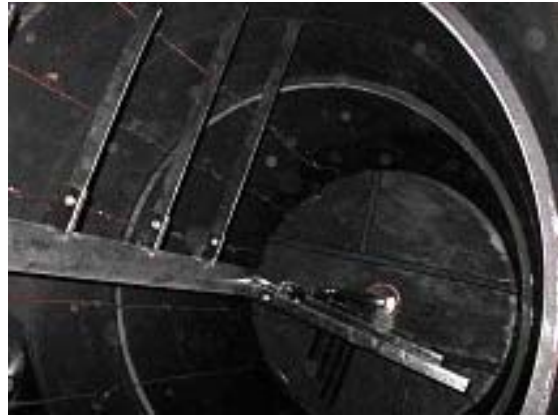
Şekil 4. Fermantasyon tankı içindeki parmaklı karıştırıcı
