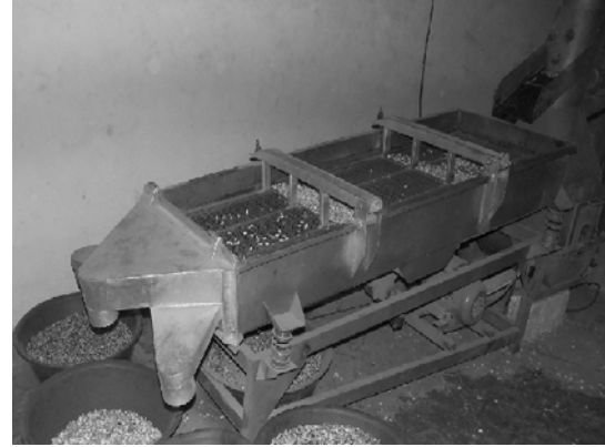
Şekil 6. Elekli sınıflandırma sistemi
