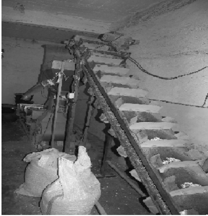
Şekil 4. Materyali hava kanalına ileten elevatör
