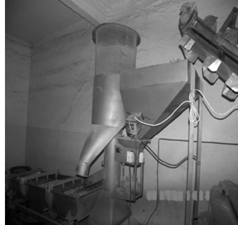
Şekil 3. Ayırma ve sınıflandırma sistemi
