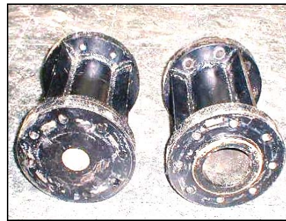
Şekil 1. Ek lastik tekerlek bağlantı elemanı
