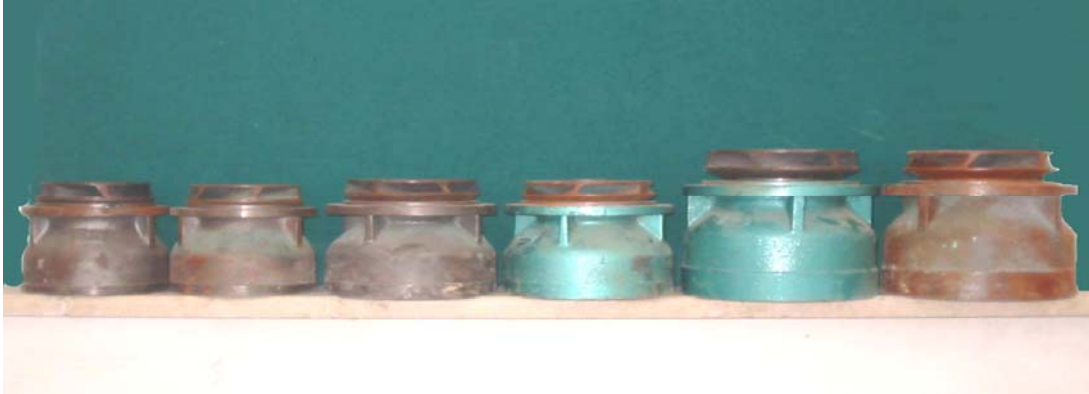
Şekil 1. Tüm pompaların çark ve gövdelerinin işlenmiş durumdaki resimleri
