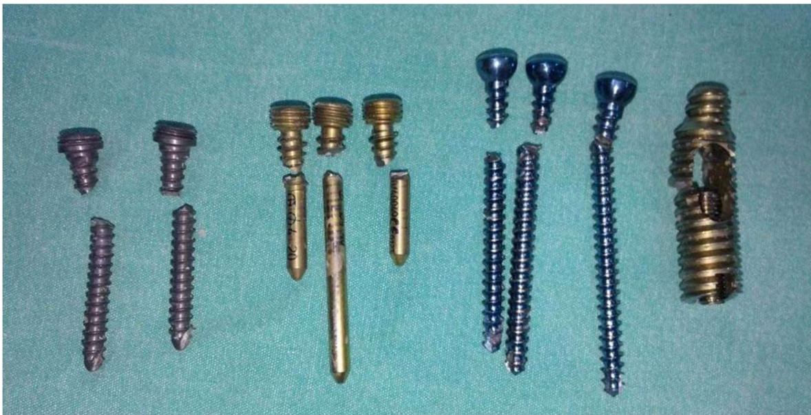
Şekil 8 c: Kırılmış vida görüntüleri sırası ile ZIMED, ORTHOFIX, TIPMED, TST
