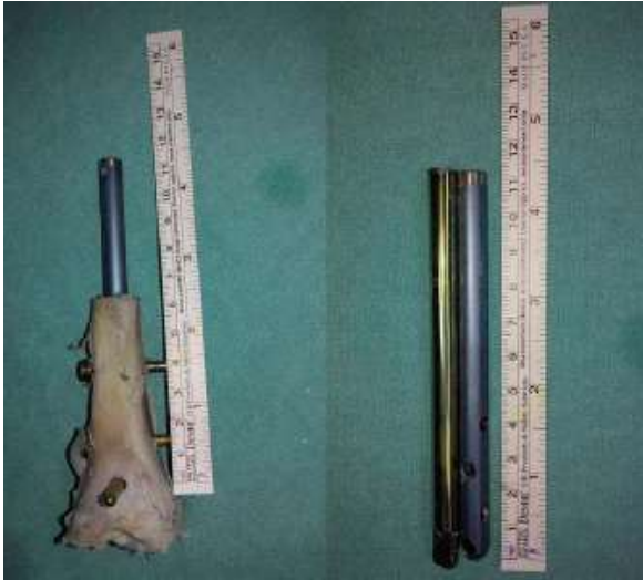
Şekil 6: Çivilerin distali 11 cm kalacak şekilde kesilmiş hali
