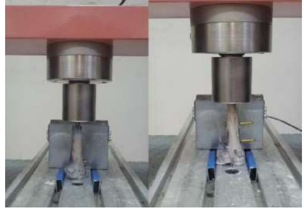
Şekil 7: Cihazda üst ve alt tabla arasında sıkıştırılmış vaziyette denekler
