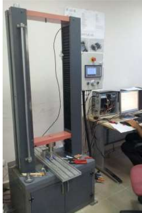
Şekil 5: Bilgisayar kontrollü Üniversal betaALŞA Çekme – Basma Test Cihazı, Kocaeli
