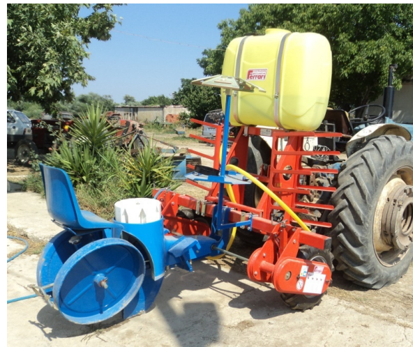
Şekil 1. Yatay magazinli fide dikim makinesi
