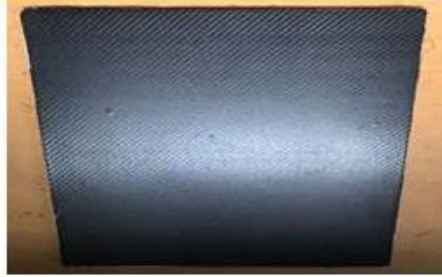
Şekil 4. Karbon fiber ve UHMW-PE hibrid kompozit plakaların; a) Yandan, b) Arkadan ve c) Önden görüşleri (Figure 4. Photos of carbon fiber and UHMW-PE hybrid composite plates; a) Side, b) Behind, and c) Front view)
