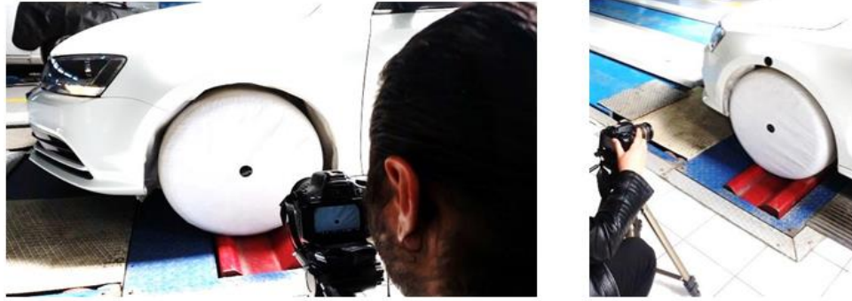
Şekil 11. Görüntü işleme prosesi için kameranın konumlandırılması.
