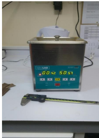
Şekil 1. Ultrasonik yıkama cihazı ve işlemi.
