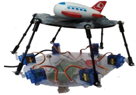
Şekil 12: Küçük Boyutlu 6DOF Prototip Uçuş Platformu Tasarımı Gerçek Görüntüsü
