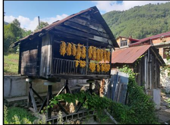
Foto 32-33- Kemirgenlerin veya yılanların ambara ulaşmasını engellemek için sürekli bir merdiven bulundurulmaz. Merdiven ihtiyaç duyulmadığında başka bir yerde saklanır ya da ambardan uzaklaştırılır.
