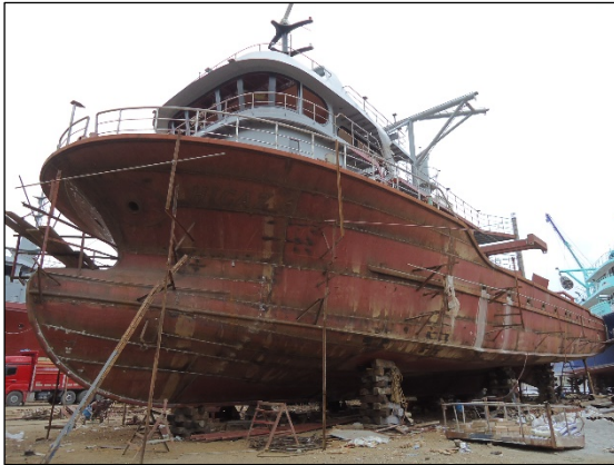
Şekil 2. Çamburnu tersane alanında inşa edilmekte olan bir Karadeniz tipi balıkçı gemisi (Fotoğraf yılı: 2013. Dursun Saral)
