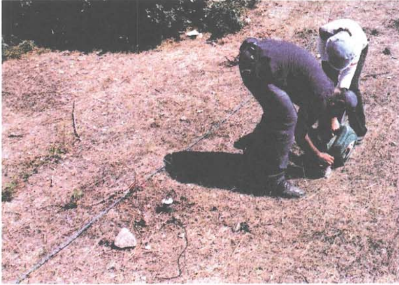
Resim 8: Akalan Alan 1’de doğru akım özdirenç çalışmaları.
