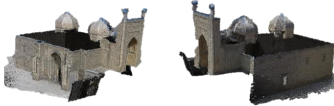
Şekil 4. Yoğun Nokta Veri Kümesi (Build Dense Cloud)
