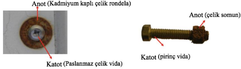
Şekil 10: Farklı metallerin yan yana gelmesi ile oluşan galvanik korozyon örnekleri
