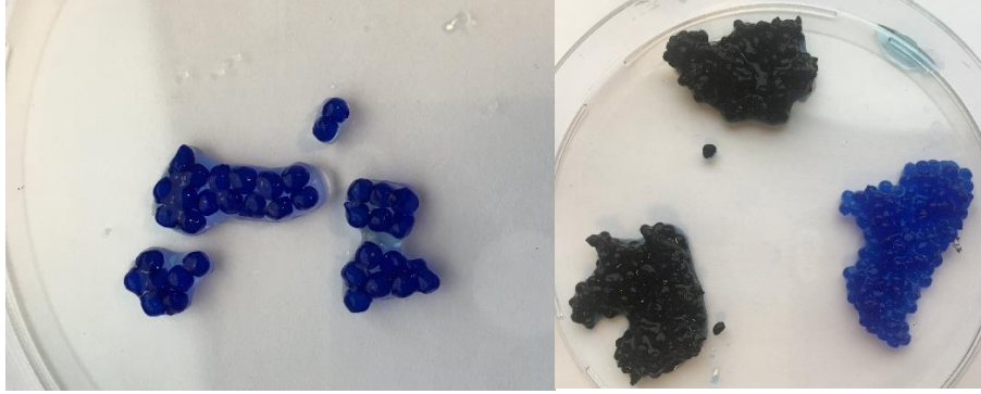
Şekil 4. Farklı metilen mavisi konsantrasyonlarında (100, 400 ve 800 mg/L) SNK katkılı aljinat ile adsorpsiyonu sonrası aljinatların görünümü.
