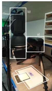
Şekil 1. Çalışmada Kullanılan Deney Düzenegi a) Hiperspektral kamera, b) Halojen lamba, c) Görüntüsü alınacak bölge, d) Hiperspektral beyaz referans plaketi
