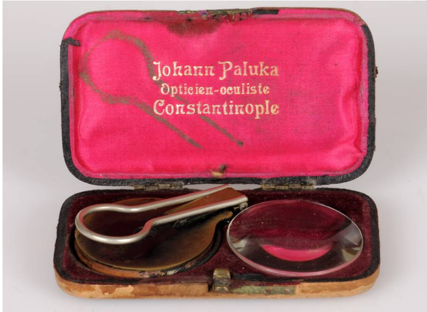
İstanbul'da gözlükçü Johann Paluka tarafından satılan bir Esat Oftalmoskopu seti (Oftalmoskop ve indirekt muayene için + 13 mercek)
