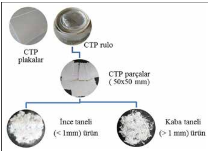
Şekil 3. CTP plaka mekanik geri dönüşüm ürünleri (ince ve kaba taneli ürünler).
