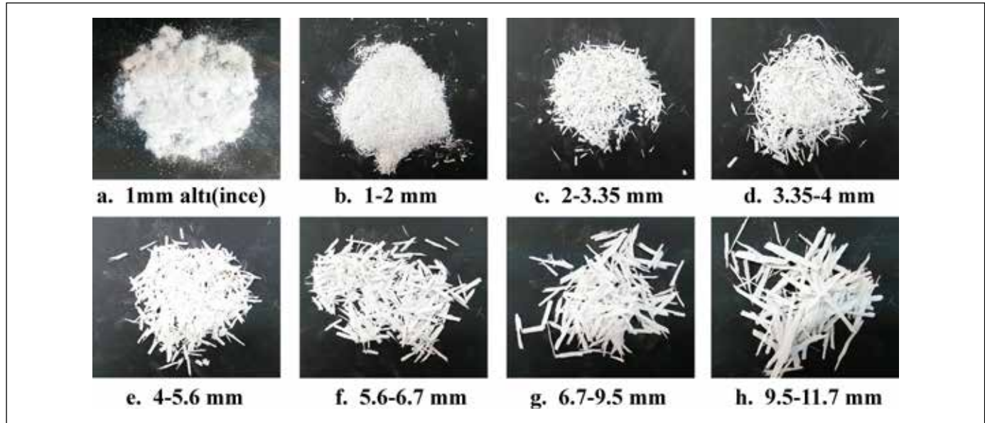
Şekil 4. CTP geri dönüşüm ürünleri. A) İnce taneli (<1 mm), B-H) kaba taneli (>1 mm).
