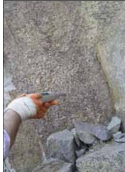
Şekil 5. Schmidt çekici deney aleti ve arazide kullanımı.
