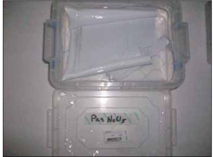
Şekil 2. %5 NaCl çözeltisi içerisinde sentezlenen PES membran.
