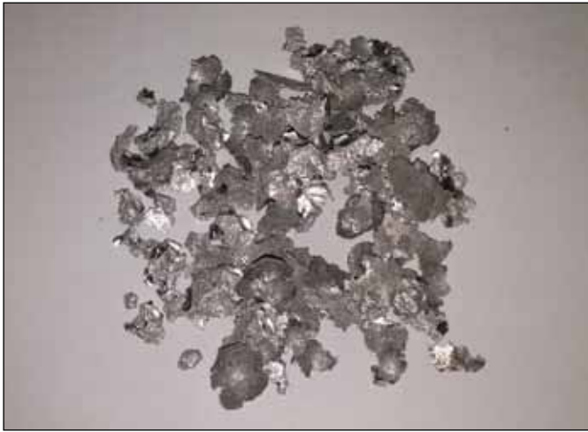
Şekil 1. Bilyalı değirmende karıştırılmış Mg-SiC karışımı.
