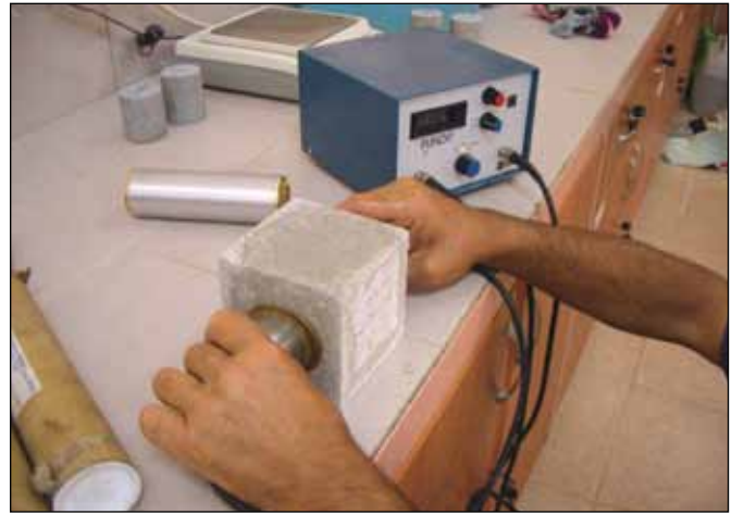
Şekil 8. Ultrases geçiş hızı bulunması işlemi.
