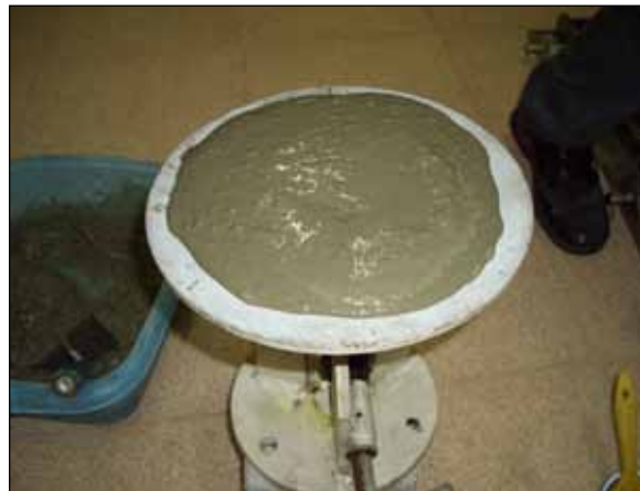
Şekil 6. Yayılma tablası ile numunenin yayılması.
